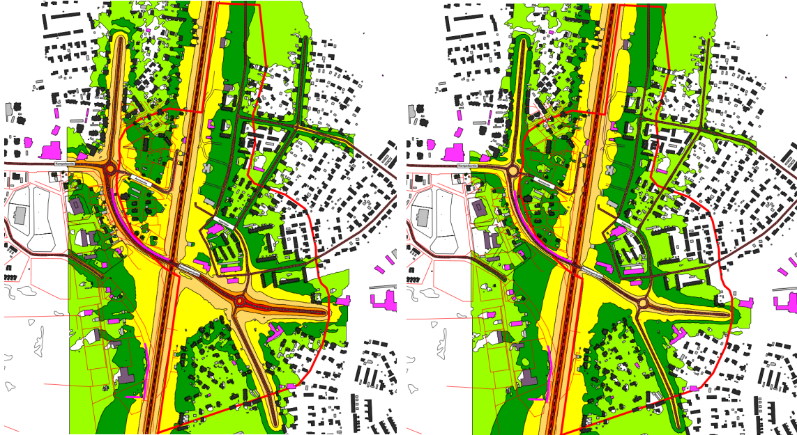
Päiväajan (vas.) ja yöajan (oik.) keskiäänitaso nykytilanteessa Aseman ympäristössä ja Riihivainiolla. Tummanvihreä tasoa 50...55. (WSP 2024)
